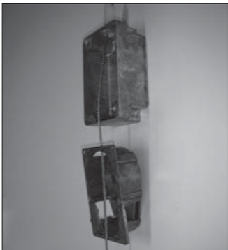
Voer het staaldraad door de muurplaat en spoelhouder.
